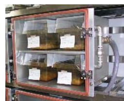
飼育箱に収められたマウス用のケージ。密閉され、空気は安全キャビネット同様、実験室に空気が流れないように陰圧になっている。
