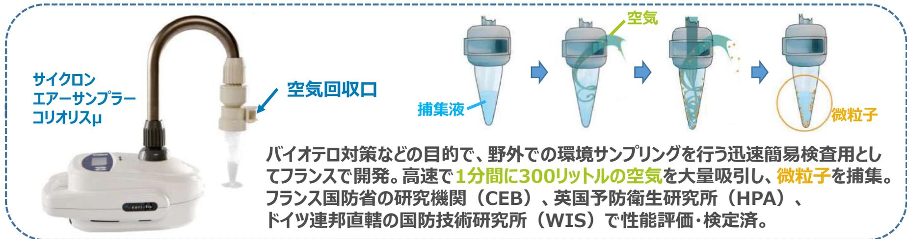
2. 10分間連続で、排気口からの空気を吸引し、10 mlの回収液が入っている捕集カップに、空気中の微粒子を捕集する。
