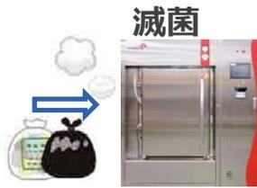
両面扉式の高圧蒸気滅菌装置に、実験室側から廃棄物を搬入し、**121℃以上で15分以上**の高圧蒸気滅菌を実施する。 **法**
