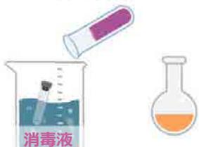
使用済みの消耗品及び実験器具等について、滅菌前に**消毒薬**に所定の時間、浸漬（漬け置き）する。その後、上記の消耗品等を実験室内の床置き式の高圧蒸気滅菌装置にて、**121℃以上で15分以上**の高圧蒸気滅菌を行う。
