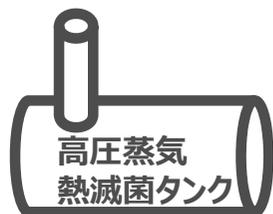
BSL-4実験室等専用の熱滅菌タンクにおいて、**121℃以上で15分以上、高温高圧での滅菌処理を行う。** **法**
