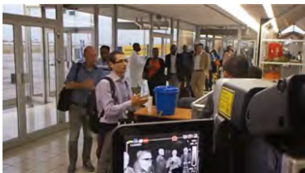
コートジボワールのアビジャンにあるフェリックス・ウフェ・ボワニ国際空港で、同時に複数の人たちの体表温度を測定しているサーモグラフィカメラ (写真：日本アビオニクス株式会社)
