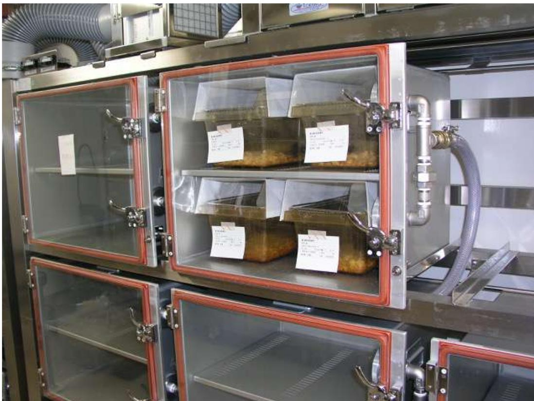
動物の居るケージは、ステンレス製の容器に収納される。
